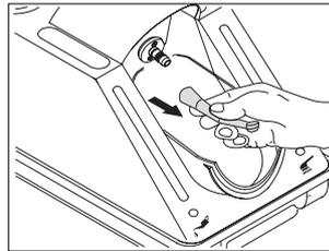
Нажмите красную кнопку деблокирования насадки для обработки и одновременно снимите передаточный инструмент.
