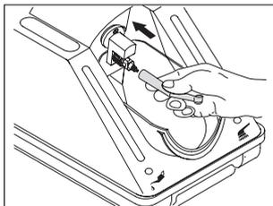
Установите турбину с быстродействующей муфтой на блок адаптера до фиксации, при этом отверстие распылителя должно быть направлено вниз. Закройте купол и поддон для утилизации.
