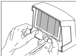
С помощью подходящего предмета выдавите пластинчатый фильтрующий элемент. Утилизируйте его как специальные отходы.
