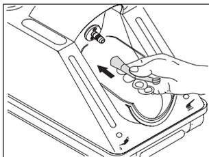
Установите передаточный инструмент на насадку для обработки до упора, при этом отверстие распылителя должно быть направлено вниз. Закройте купол и поддон для утилизации.
