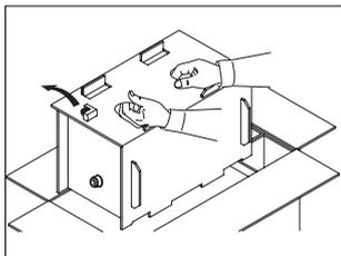
Снимите адаптер для турбины.
