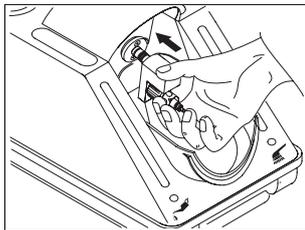
Установите блок адаптера или блок адаптера с турбиной на насадку для обработки до упора.
