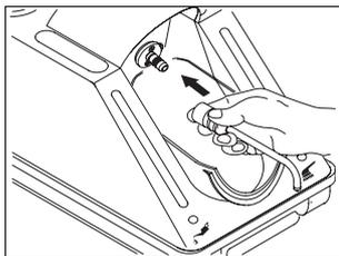
Наденьте адаптер T1 на насадку для обработки выходным отверстием вниз.
