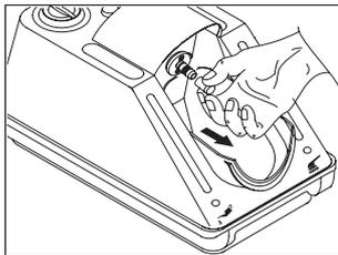
Снимите колпачок с насадки для обработки и уберите его в надежное место.
