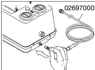
Вставьте быстродействующую муфту соединительного шланга в соединительный разъем устройства Assistina. С помощью резьбового соединения 1/8" произведите подключение к существующей линии сжатого воздуха.
