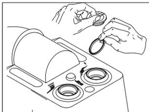
Отвинтите обе пробки и удалите оба транспортных уплотнения (опасность функциональной неисправности)!
