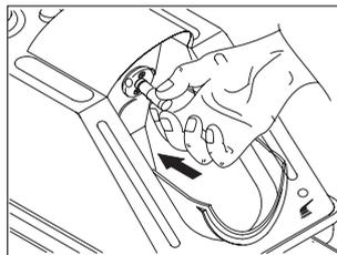
Установите колпачок № 02676400 на насадку для обработки.
