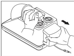
Снимите отсасывающий фильтр, держа его горизонтально.
