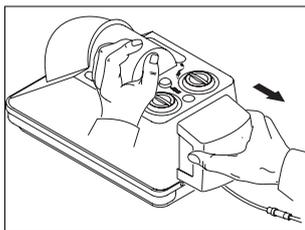
Снимите отсасывающий фильтр в направлении назад, держа его горизонтально.
