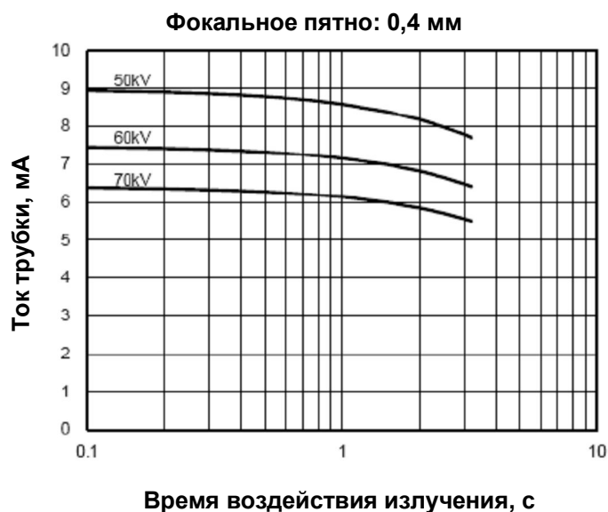
< Рис 1.6.3.1 Максимальная выходная мощность рентгеновской трубки >
