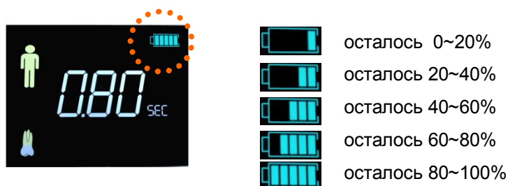
< Pic1.9.4.1 Состояние батареи >
